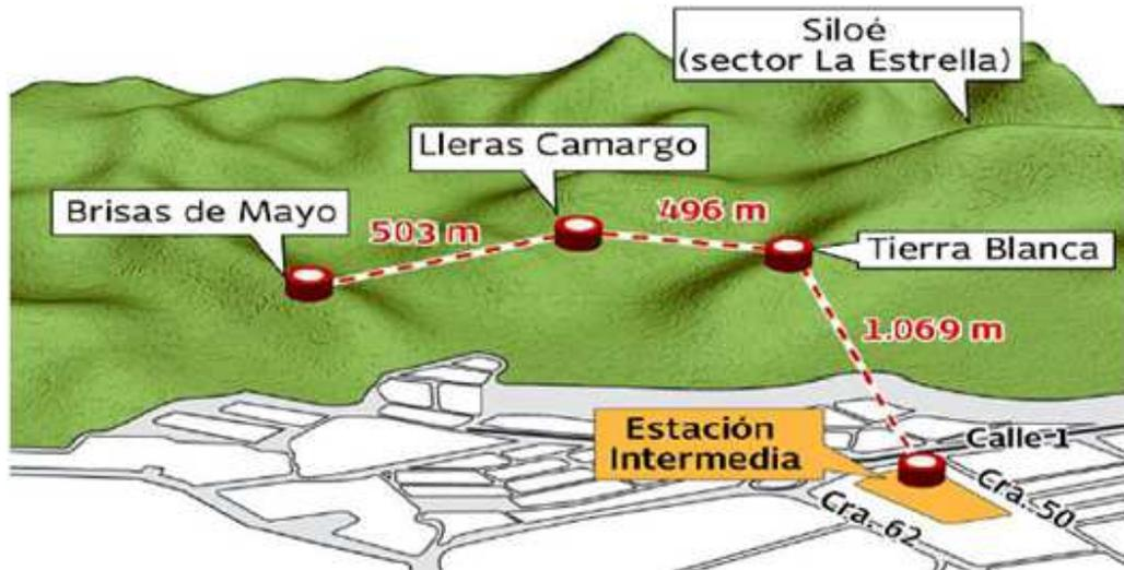
El sistema funciona con 60 cabinas en forma de diamante con capacidad para 10 pasajeros, 8 sentados y 2 de pie, cada góndola tiene una frecuencia de 14 segundos y su velocidad es constante de 5m/s o 18 km/h.
